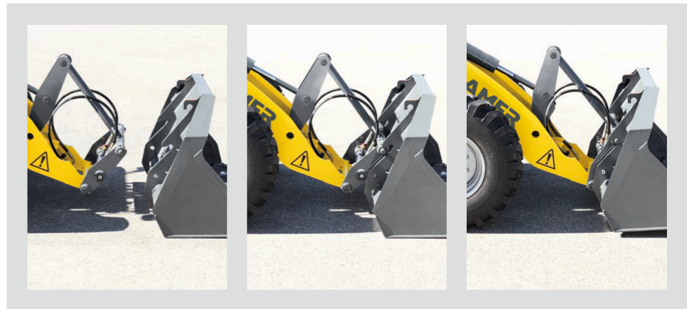
Ogni cambio dura pochi secondi grazie al dispositivo idraulico a cambio rapido.
